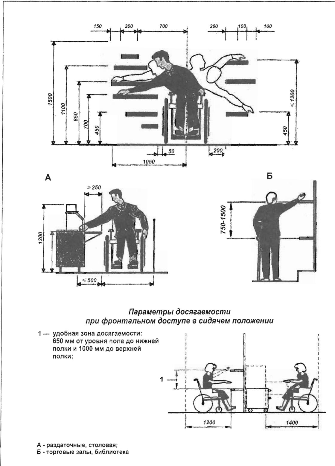
Рисунок Д.2 – Зоны досягаемости и эргономические параметры
